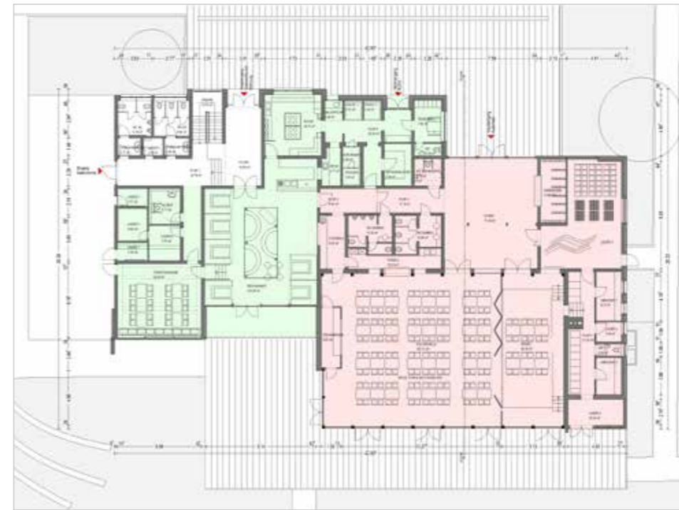
Grundriss Erdgeschoss nach Neuplanung. Kulturhalle (rötlich gefärbt) im ehemaligen Hallenbad, Restaurant (grünlich)
